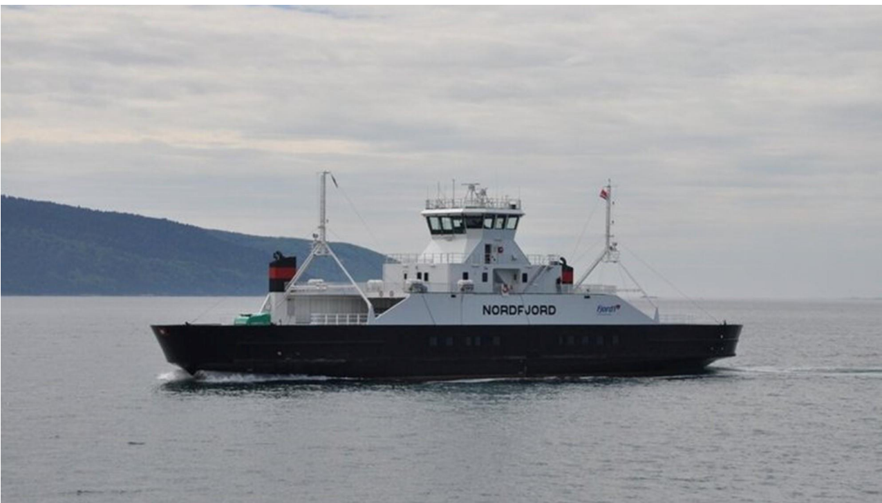
Figur 2-1 MF Nordfjord som trafikkerer sambandet i dag. MF Nordfjord er 72 m lang, 15 m brei og har djupgang på 3,5 m. Kjelde: Fjord1.
