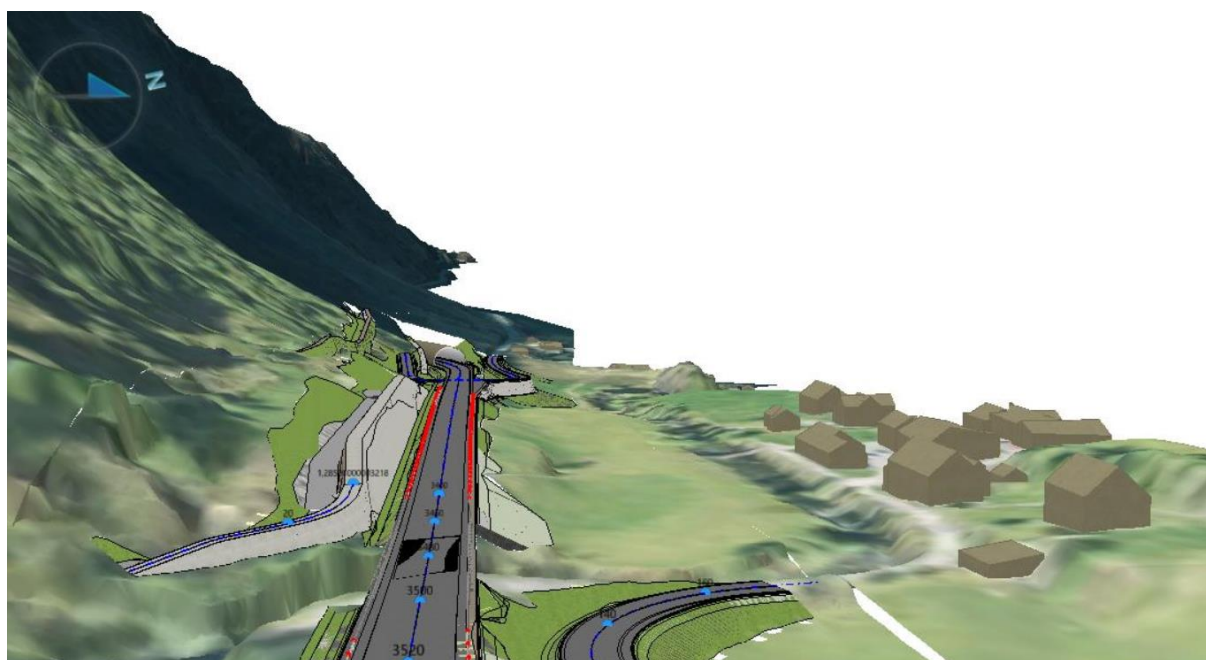
Figur 48 Snip frå prosjektert steinsprangvoll nærast Heilevangbrua og vestover.
