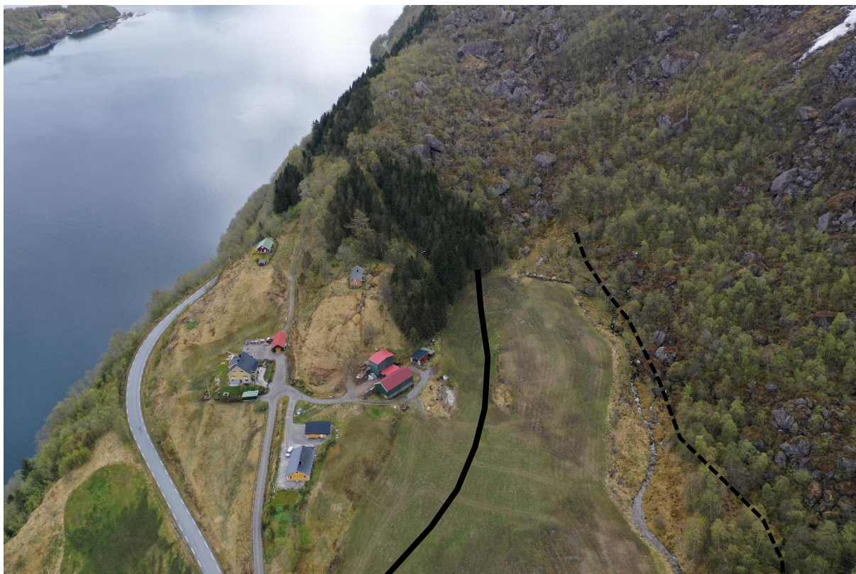
Figur 27 Bilete som viser urfot (stipla linje) og planlagt veg (strek).
