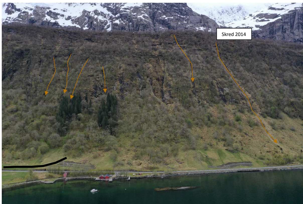
Figur 31 Dronefoto som viser potensielle jord- og flaumskredbaner i fjellsida over påhoggsområdet.
