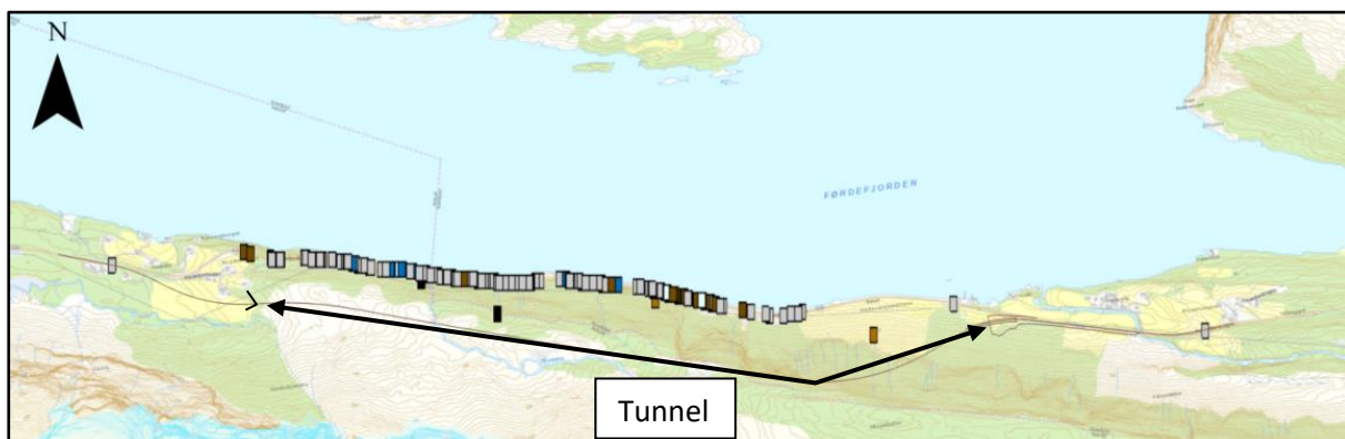
Figur 23 Kart som viser skredhendingar (farga boksar) og veglinje 14 000. Tunnellengda er markert med pil.
