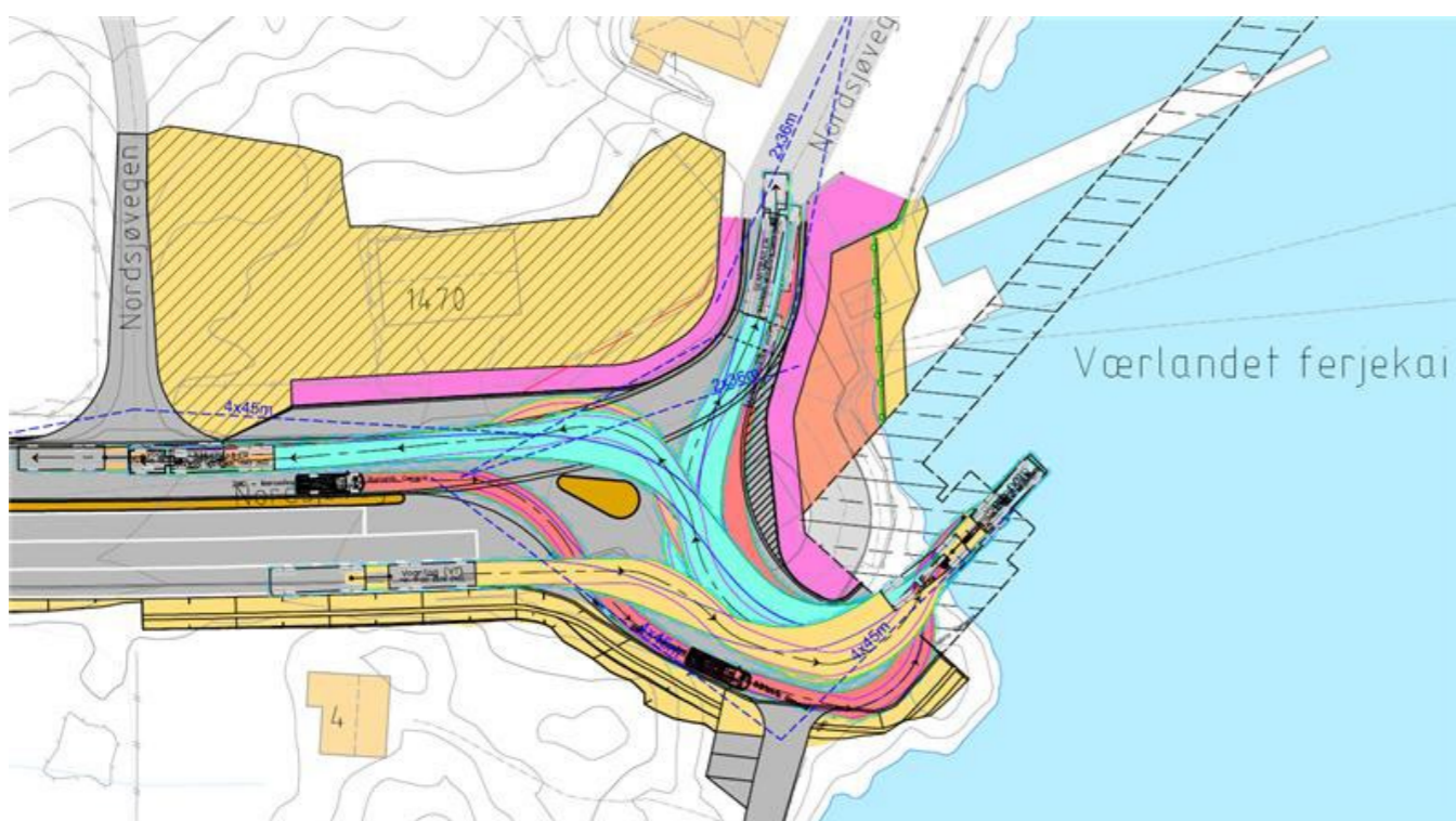
Figur 6-11 Sporingsmodell for av- og påkøring til ferja. Dimensjonert for vogntog (VT). Multiconsult.
