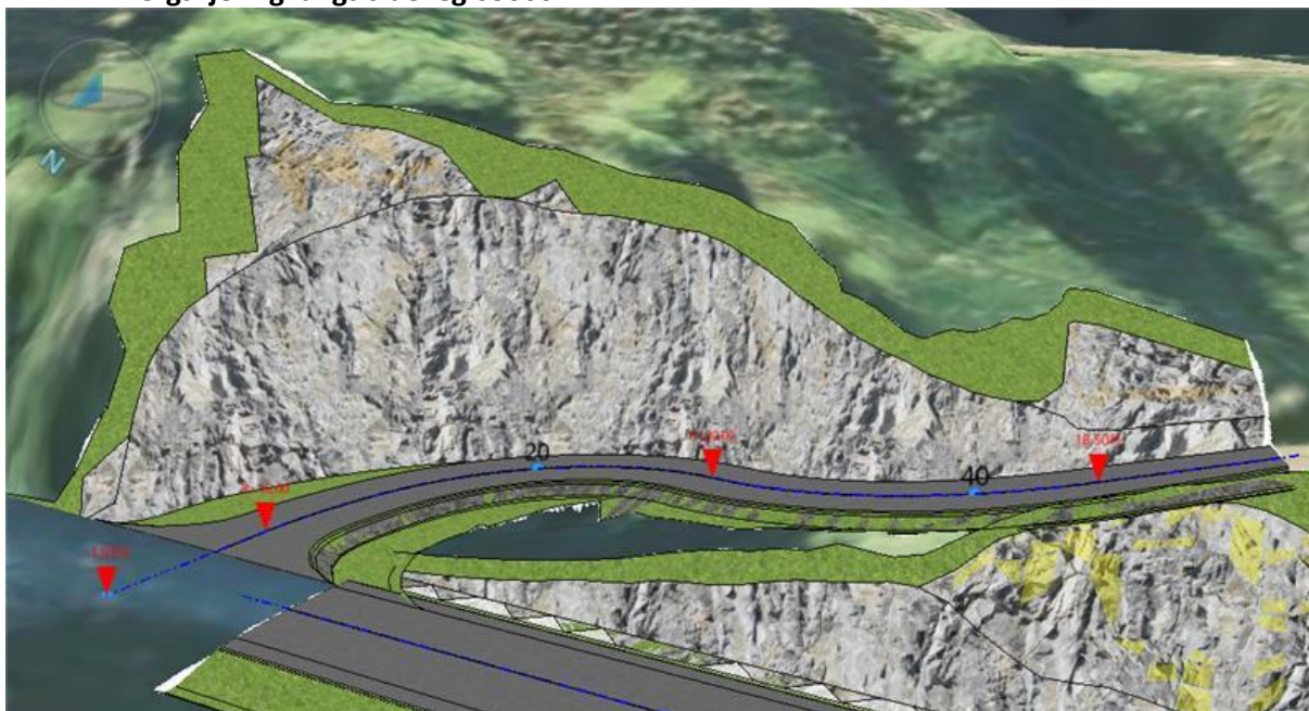
Figur 9: Bergskjering langs sideveg 63600. Maksimal høyde 11 m.
