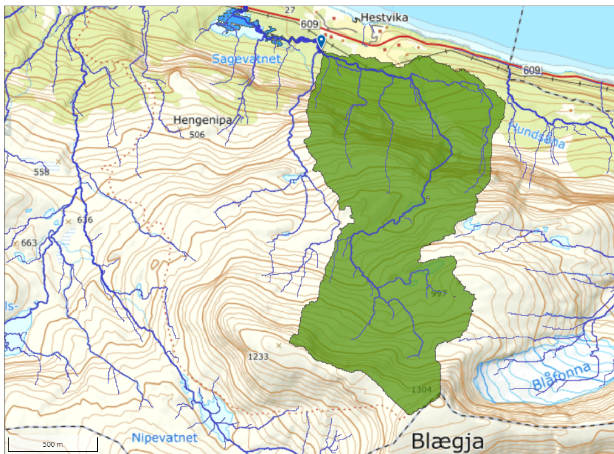
Figur 5. Nedbørsfeltet til bekken, generert i Scalgo Live.
